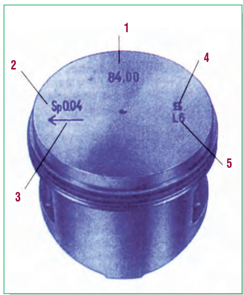
Σχήμα 4.16: Χαρακτηριστικά σημάδια εμβόλων.
